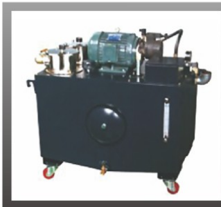
CTS中心出水设备 CTS Center Water Outlet Equipment Оборудование для выпуска воды центра CTS
