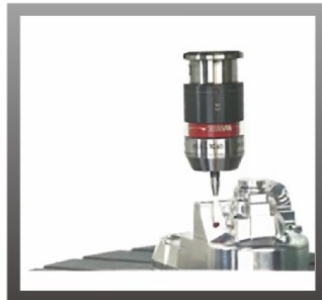
接触式工件测量系统 Contact-type Workpiece Measurement System Система измерения контактной заготовки BRC无线电传输技术 重复性: 0.3um 最大测量速度: 3m/min 检测工件位置/修正工件旋转偏移 BRC Radio Transmission Technology Repeatability: 0.3um Max. measuring speed: 3m/min Detect workpiece position/correct workpiece rotation offset Технология радиопередачи BRC Повторяемость: 0,3 мкм Максимальная скорость измерения: 3 м/мин Обнаружение положения заготовки/правильное смещение вращения заготовки
